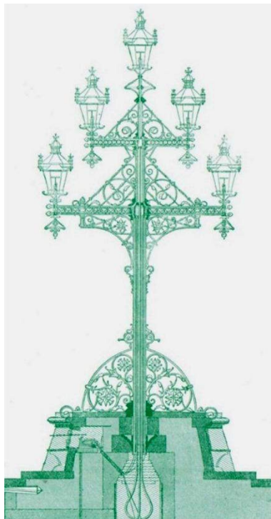
Разрез уличного фонаря газового освещения, XIX в.
