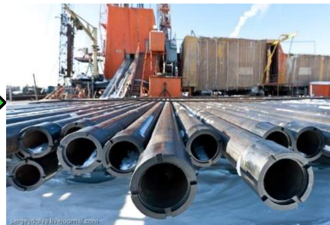
Крепление ствола (обсадные трубы, наращивание труб)
